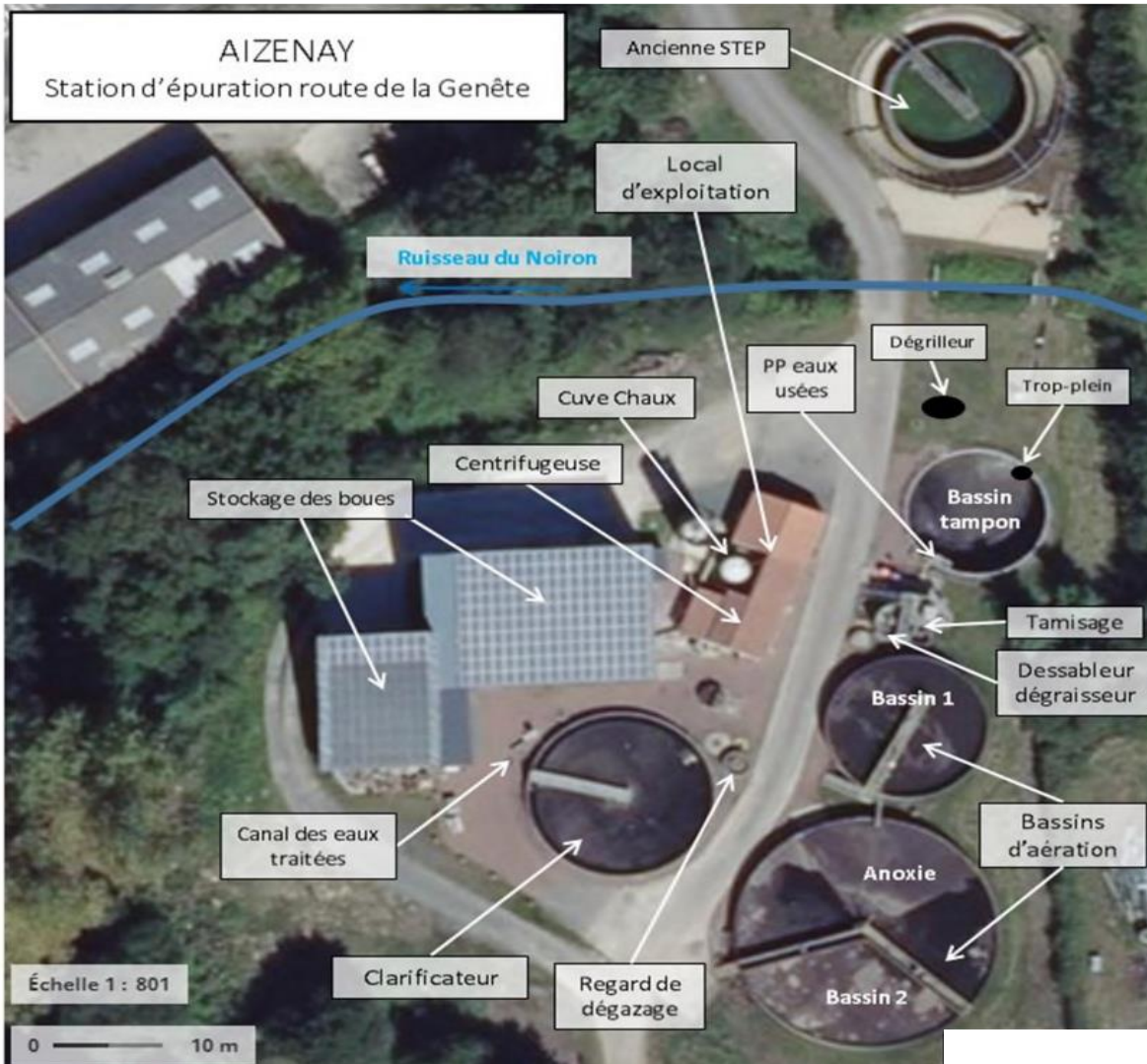
Figure 4 : Vues station d'épuration actuelle
